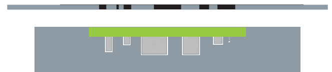
Second Pass / 2. Durchgang – Leiterplattenunterstützung mit Bauteil-Aussparungen
