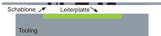
First Pass / 1. Druckdurchgang – Leiterplattenunterstützung mit durchgehender flacher Auflage
