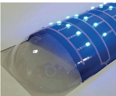
Beispiel einer vakuumgeformten Probe 50% Dehnung
