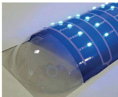
Exemple d'un échantillon formé sous vide avec 50% d'allongement
